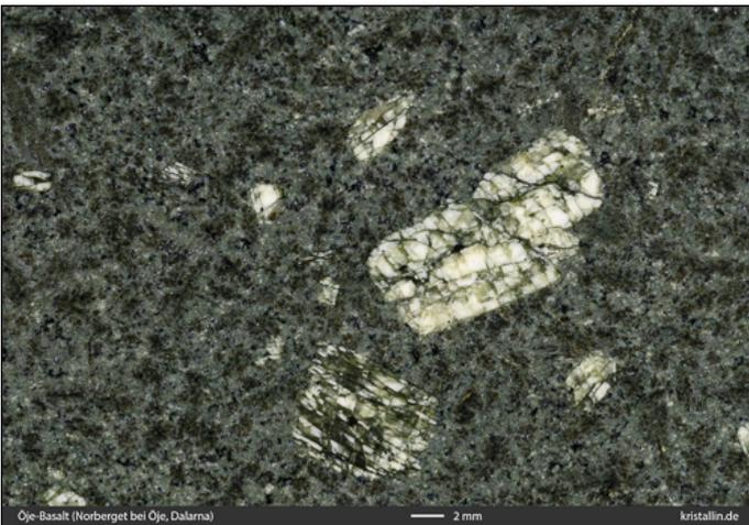
Bild 13: Ausgeprägt körnige Grundmasse im Öje-Basalt (polierter Schnitt)
