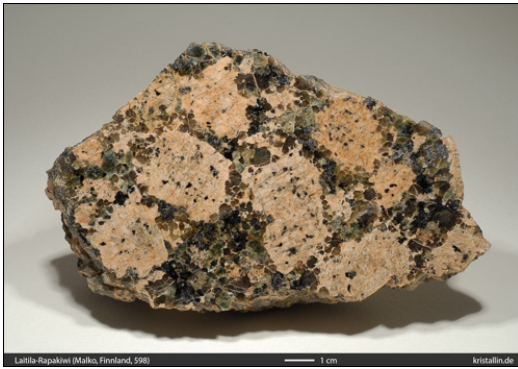
Bild 16 (links): Grobkörniger Pyterlit von Malko, nordöstlich von Laitila (598)
