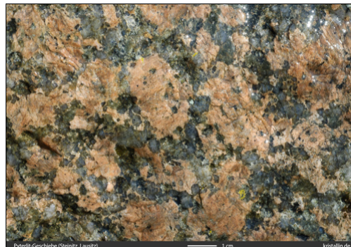
Bild 55: Hellbrauner Alkalifeldspat, grauer Quarz, brauner Plagioklas
