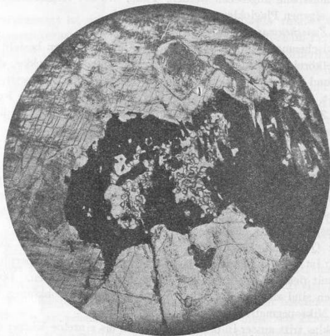
Fig. 8. Knollen von Hornblende (dunkle Partie im Zentrum), Glimmer (dunkle Partie rechts), Quarz und Fluorit, der ein grösseres Quarzkorn (unten) teilweise umschliesst. Das ganze Gebilde bildet einen Einschluss in einem grossen Orthoklasball (Orthoklas oben und links im Bilde) des Wiborgits von Muhutlahti in Säkijärvi. Vergrösserung 22 \times . Parallele Nicols.
