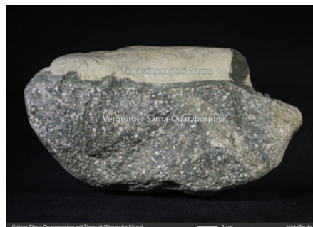
Bild 56: Weitgehende Grünfärbung (Polierter Schnitt, Kiesgrube Särna)
