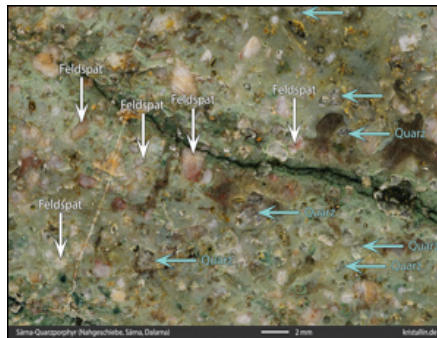
Bild 61: Zur Bestimmung braucht man die Feldspäte und Quarze
