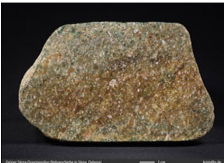
Bild 56: Weitgehende Grünfärbung (Polierter Schnitt, Kiesgrube Särna)
