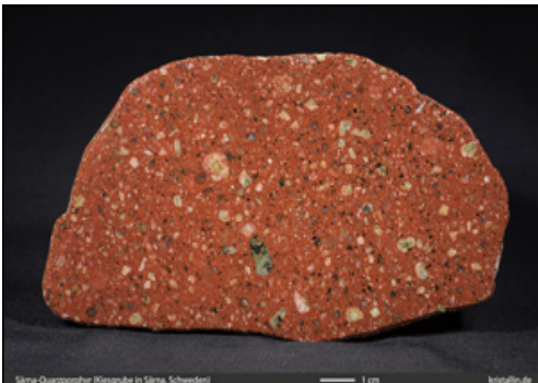
Bild 34: Braunroter Särna-Quarzporphyr, Kiesgrube Särna (Polierter Schnitt)
