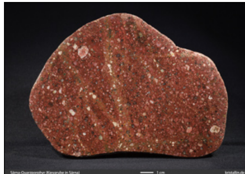
Bild 34: Braunroter Särna-Quarzporphyr, Kiesgrube Särna (Polierter Schnitt)
