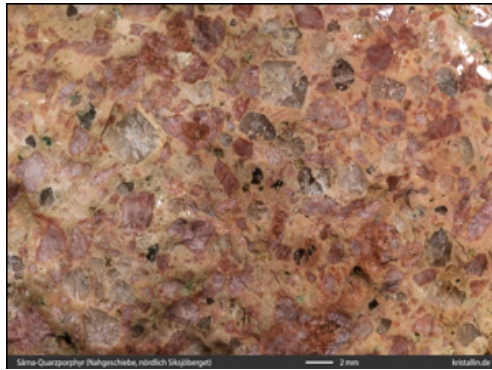
Bild 38 (links): Kein Kallberget-, sondern Särna-Quarzporphyr
