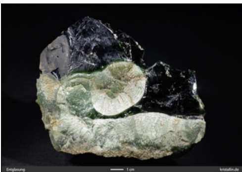
Bild 16: Bruchstück mit Entglasungen
