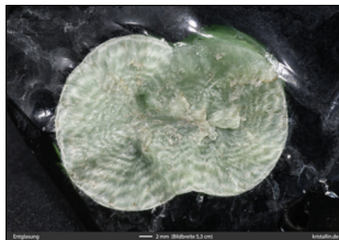
Bild 17: Konzentrische Rekristallisation in Glas
